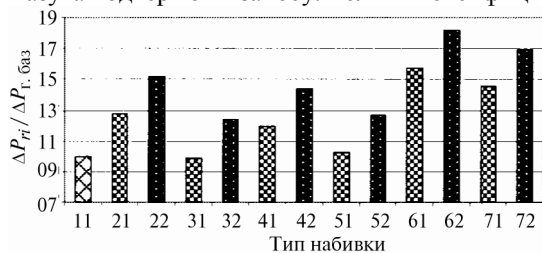
Рис. 3. Влияние типа набивок на относительное общее сопротивление РВП по газам
