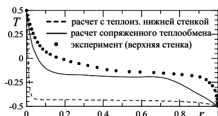
Рис. 2. Рассчитанные профили осредненной во времени температуры на внутренней поверхности нижней стенки и экспериментальное распределение температуры на верхней стенке полости
