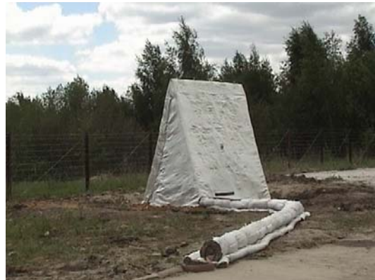
Рис. 3. Общий вид огнезащитного укрытия, установленного на имитаторе устья нефтяной скважины с запорной и фонтанной арматурой
