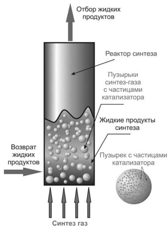
Рис. 4. Схема проточного реактора синтеза Фишера-Тропша
