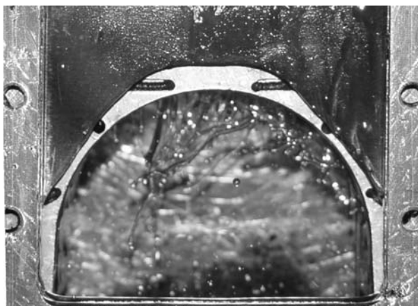
Рис. 8. Отрыв плёнки масла при ходе поршня вверх
