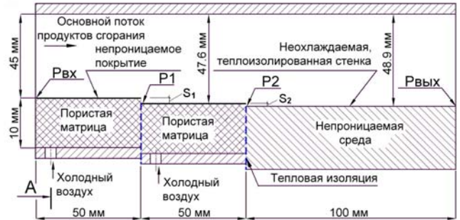
Рис.1. Схематический вид экспериментального канала. Условия на входе: T^* = 1773 К, M = 1.22 , U = 990 м/с. Высоты ступенек: S_1 = 2.6 , S_2 = 1.3 мм
