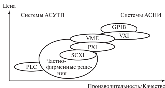
Рис. 1. Области эффективного использования различных вариантов средств автоматизации
